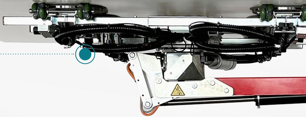
**Herunterschieben:** Beim Kippen um 180° lösen sich die Saugnäpfe automatisch, und die Platte kann mühelos über die integrierten Rollen vom FlexiMoveMaster IQ herunterschieden werden.
